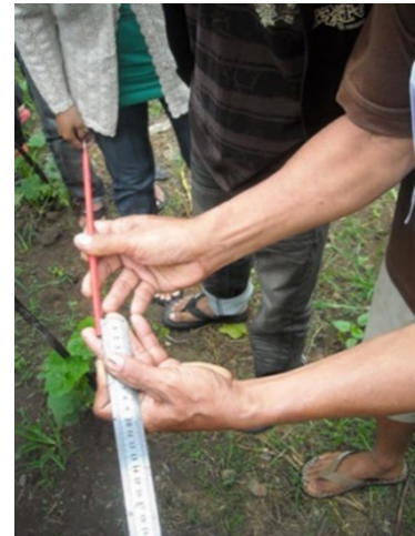
ພາບ C-2: ຊາວກະສິກອນນຳໃຊ້ໄມ້ບັນທັດເພື່ອແທກເບິ່ງລະດັບນ້ຳຂອງດ້ານວັດແທກສ່ວນທີ່ປຽກນ້ຳ, ທີ່ກຳລັງຊີ້ບອກໃຫ້ຮູ້ວ່າປະລິມານນ້ຳຝົນທີ່ຕົກລົງມາພາຍໃນ 24 ຊົ່ວໂມງຜ່ານມາມີຈັກ ມິລິແມັດ. (ຖ່າຍໂດຍ Y.T. Winarto)
