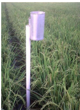
ຮູບ C-1: ເຄື່ອງວັດປະລິມານນ້ຳຝົນທີ່ເຮັດຂຶ້ນເອງໃນບ້ານຂອງຊາວນາ Indramayu. (ຮູບຖ່າຍໂດຍ B. Dwisatrio)
